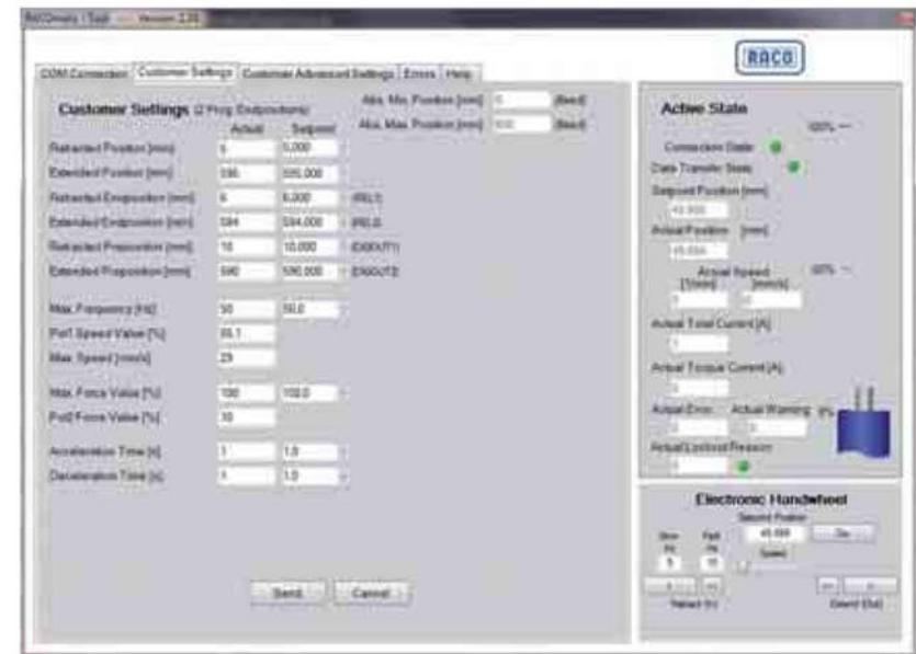
Das einzigartige RACOMatic® Tool - die Anwendersoftware aus dem Hause RACO - reduziert die ca. 800 Stellgrößen, die aus der Kombination von Frequenzumrichter und Sensorik resultieren, sinnvoll auf die wenigen, für Ihre Anwendung benötigten Parameter.
